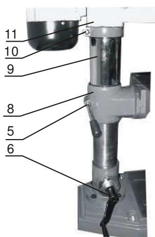
Для регулировки высоты головки необходимо ослабить зажимной рычаг (5). При помощи рукоятки (6) выверните патрон стола на такую высоту, чтобы дистанционная гильза (9) соприкасалася с патроном головы (11). Ослабьте болт фланца (10), установите высоту головы на требуемый уровень и зафиксируйте болт таким образом, чтобы голова была неподвижной. Рукояткой (6) установите требуемую высоту стола и затяните зажим стола (8). При необходимости снова изменить высоту стола, всегда следуйте данным указаниям.
