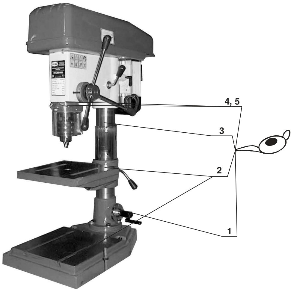
которое можно использовать для смазки обозначенных поверхностей станка (см. фото).
