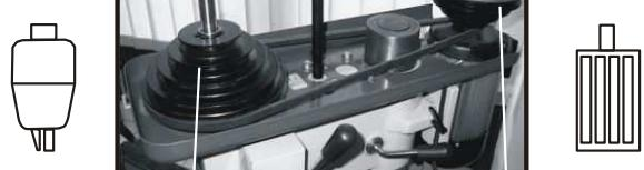
Для того, чтобы изменить скорость вращения, прежде всего, остановите двигатель, откройте крышку, ослабьте зажимные болты двигателя, а рычаг натяжения потяните по направлению к
